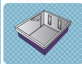
3 上枠を取り付けます。上枠内側、外側に緩衝材(付属品)を取り付けます。
