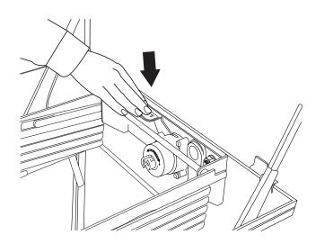
注意 レバーは完全に倒れるまで手で押して下さい。展張中に Caution レバーを戻したり、倒れきらない場合は緩降装置が破損 し、はしごの収納や展張が出来なくなる原因になります。
